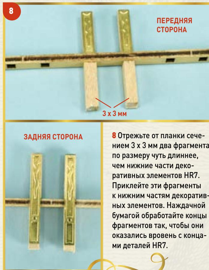
**8** Отрежьте от планки сечением 3 x 3 мм два фрагмента, по размеру чуть длиннее, чем нижние части декоративных элементов HR7. Приклейте эти фрагменты к нижним частям декоративных элементов. Наждачной бумагой обработайте концы фрагментов так, чтобы они оказались вровень с концами деталей HR7.
