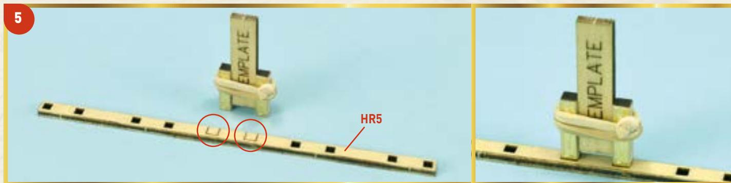
**5** Извлеките деталь HR5 из деревянной матрицы и обработайте ее края надфилем. Приклейте обе стойки в центральной части детали HR5, перпендикулярно к ней (см. фотографию).
