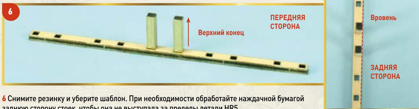
**6** Снимите резинку и уберите шаблон. При необходимости обработайте наждачной бумагой заднюю сторону стоек, чтобы она не выступала за пределы детали HR5.
