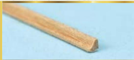
**20** Возьмите одну из реек 2 x 2 x 200 мм, которые прилагались к выпуску 66. Обработайте рейку, чтобы придать ей указанный на фотографии слева профиль. Затем обработайте рейку мелкозернистой наждачной бумагой и покройте одним слоем морилки цвета «орех».
